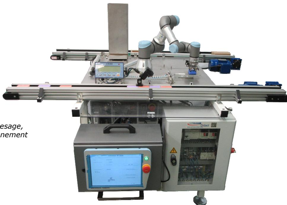
*UR3 dans un scénario de pesage, échantillonnage et conditionnement de savonnettes.*
