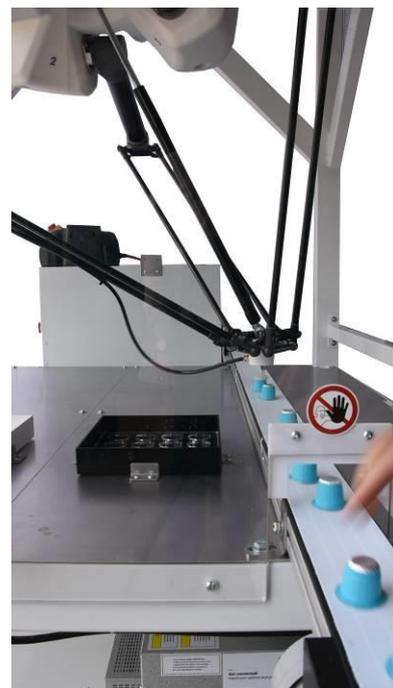
**ROBOTICC - D est un système didactisé dont l'élément central - un robot Delta\* industriel à 4 axes - évolue dans une application de prise/dépose à la volée et de conditionnement de produits manufacturés.**
